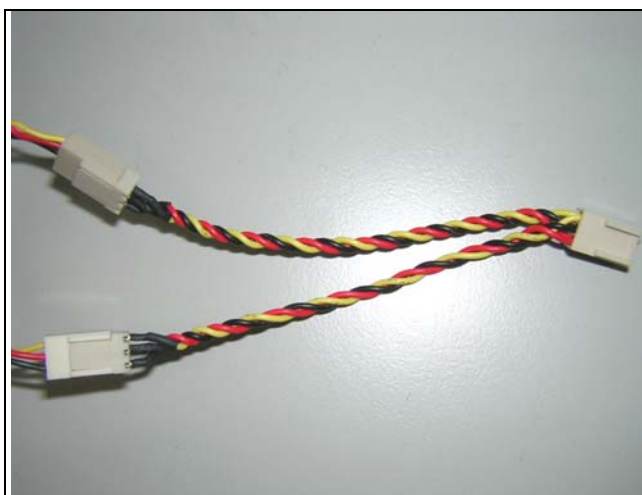
Fig. 4-5 Connect two fan cable
