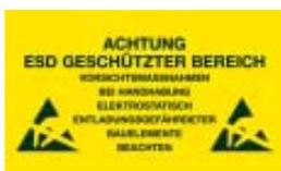
Bei geöffnetem Gehäuse sind die Bauteile nicht mehr ESD geschützt. Beim Berühren sind unbedingt geeignete Maßnahmen (Erdung, Antistatik) zu treffen, um elektrostatische Entladungen auf die Bauteile zu verhindern.
