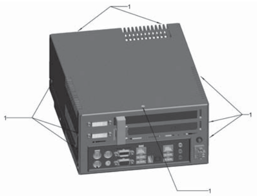
Zum Öffnen Schrauben (1) lösen
